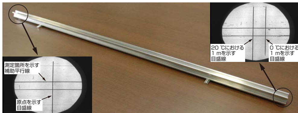
メートル原器と原点目盛線(左下)、20℃における1 mを示す目盛線、0℃における1 mを示す目盛線(右上)
