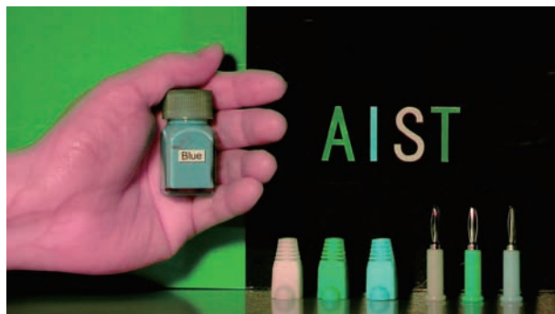
図2 今回開発した赤外線カラー暗視カメラにより撮影された暗闇中の被写体の撮像例
