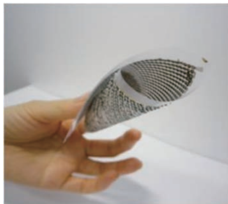
印刷法により作製したフレキシブル熱電変換フィルム (左) とその発電能力 (右)
