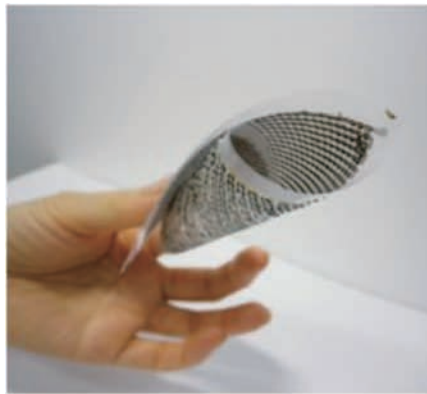
印刷法により作製したフレキシブル熱電変換素子（左）とその発電能力（右） 約10℃のプレート上に設置した試作素子に、手を置くことで温度差を加えた結果、108.9 mVの電圧が発生している。
