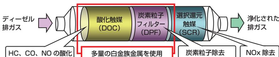
図1 大型ディーゼル車両用排ガス浄化触媒の模式図
