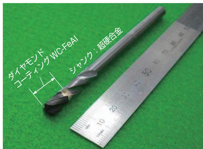
図2 試作したダイヤモンドコーティング WC-FeAl ドリル
