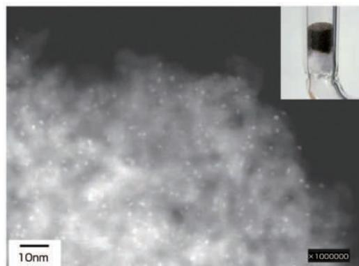
図1 開発した触媒の HAADF-STEM 像と光学写真
