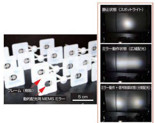
図2 この特許技術で作製した光ミラーMEMSデバイスと動的配光制御の例 MEMS構造を金型に加工し、成形を行うことによりMEMSデバイスを製造できる。
