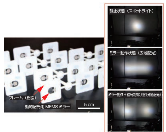
図 2 この特許技術で作製した光ミラー MEMS デバイスと動的配光制御の例
