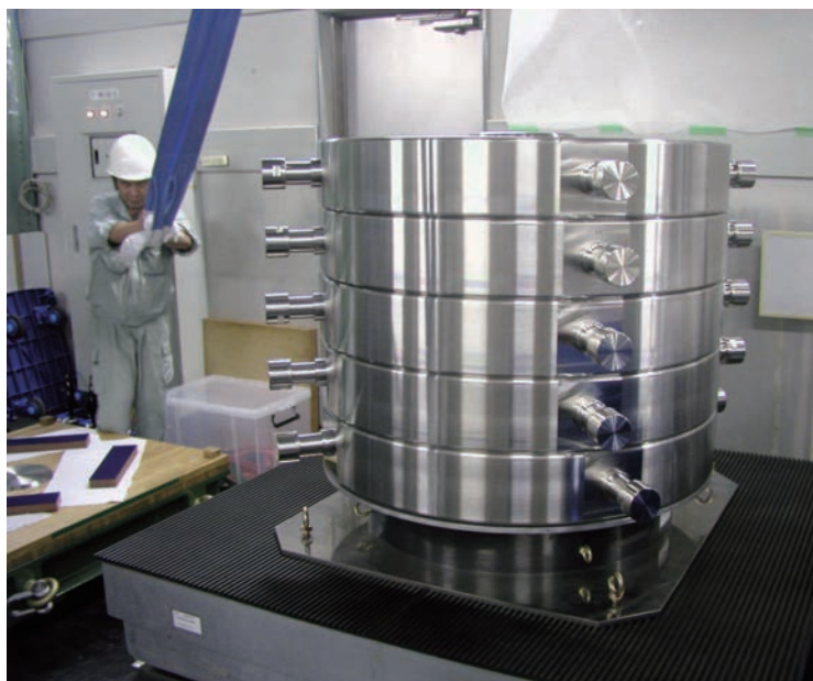
開発した質量比較器を用いた5個の1,000 kg 参照分銅による5,000 kg 分銅校正の様子
