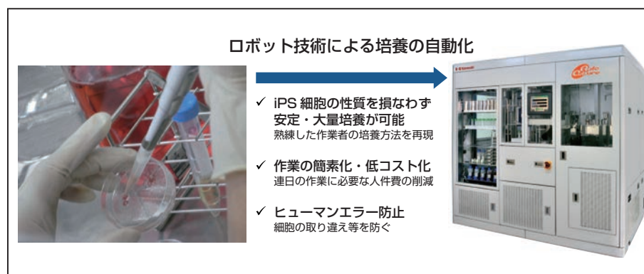
図3 ヒトiPS細胞培養の自動化 2010年6月に発表したヒトiPS細胞自動培養装置(右)は、高さ2.1m、横幅2.2m、奥行き1.4m。(写真提供:川崎重工業株式会社)
