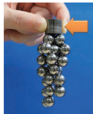
図2 今回開発した重希土類元素を含まない高性能焼結磁石 (Sm-Fe-N系) 高性能焼結磁石を2段重ねにしたものに、鉄球30個が磁着している
