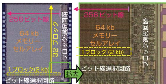
図1 今回作製したチップの全体写真 (左) とチップの右下隅を拡大した光学顕微鏡写真 (右)
