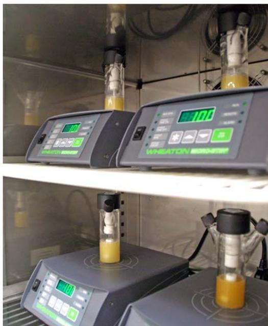
図2 作製した酵母株の発酵試験
