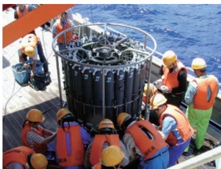
図1 学術研究船白鳳丸（JAMSTEC/東京大学大気海洋研究所）での海洋観測風景 左：大勢でロゼットサンプラー（多筒式採水器）から海水サンプルを分取中。写真提供：齊藤 宏明氏 右：船内実験室での試料処理（手前は限外ろ過による海水の分子量分画処理、筆者は奥）。 写真提供：山田 奈海葉氏
