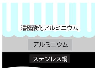
図1 今回のCIGS太陽電池で利用したフレキシブル基板の断面模式図
