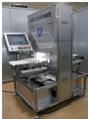
図1 全周3次元形状計測システム
