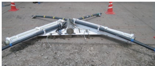
図1 開発した浅海用の海底電磁探査装置
