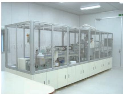
図1 太陽電池モジュール試作・評価用プラットフォームの例 (左) 結晶シリコン系太陽電池モジュール配線装置 (右) 大型真空ラミネーター
