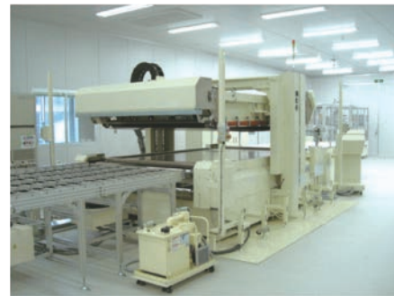
図1 太陽電池モジュール試作・評価用プラットフォームの例 (左) 結晶シリコン系太陽電池モジュール配線装置 (右) 大型真空ラミネーター
