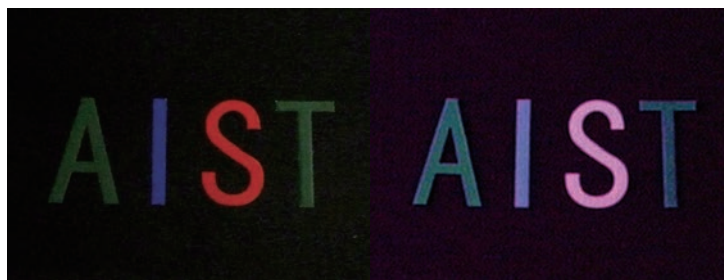
図1 蛍光灯照明下における通常のカラー撮像例(左)と今回の研究開発による暗視撮像例(右)
