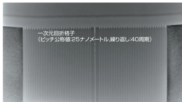
図1 Si/SiO<sub>2</sub>多層膜構造を貼り合せて作製した一次元回折格子（ピッチ公称値：25 ナノメートル、繰り返し：40 周期）の断面透過電子顕微鏡像
