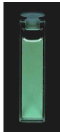
SWCNT 内部空間に作られたコロネン 1 次元結晶の透視型電子顕微鏡像図 (左上) とその模式図 (左下) および水溶液から得られた蛍光写真 (右)
