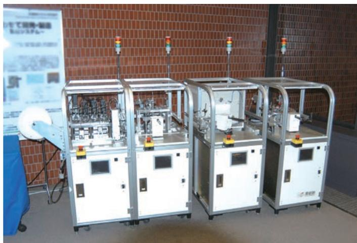
図1 試作したオンデマンドMEMS製造装置
