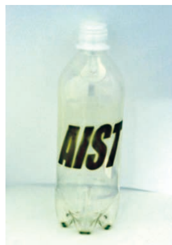
図2 容器外部に「AIST」の形に外部電極を配置してDLC膜を内面に成膜したPET瓶 内面に成膜されているので、消すことは困難。
