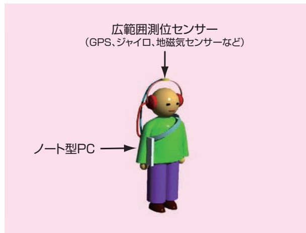
図3 総合的な訓練ができるシステムの実用版。普通のPCと、低価格の位置センサーだけで構成し、視覚障がい者のリハビリテーションの現場でも導入できるように低価格と小型化を実現した。
