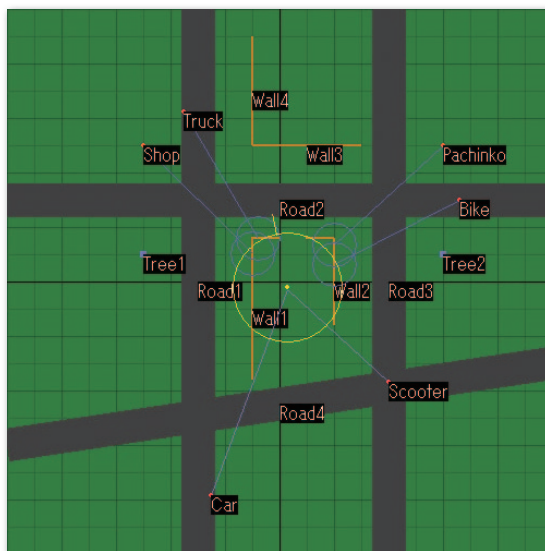
図1 3次元音響をつかった視覚障がい者の歩行訓練システムの動作画面 画面の中に、音を出す自動車や、音を跳ね返したり遮ったりする壁が配置された訓練環境が表示される。
