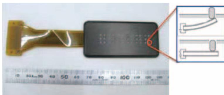
図3 2009年厚労省障害者自立支援機器等研究開発プロジェクトの成果によるバッキーゲルアクチュエーターを用いた点字ディスプレイのプロトタイプと作動断面図
