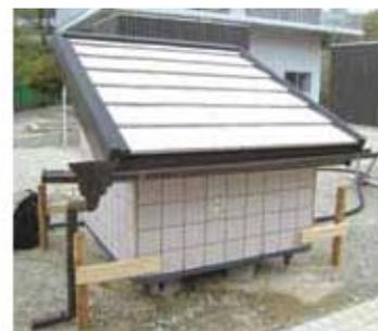
は、保水力、蒸発速度、吸水速度や吸水率（気孔率）、密度、強度などの指標があります。原料の粒度調整、原料選択、成形条件などを最適化して、30 vol%以上の気孔率を保ちつつ十分な強度が得られました。また、蒸発特性などの制御のため、微細構造と特性の関係を解析しました。
