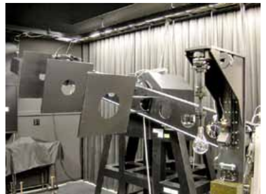
図2 分光全放射束の校正に使用される配光測定装置。光源から任意の角度方向に放射される光の分光放射束を、全空間に対して測定することで分光全放射束を校正する。
