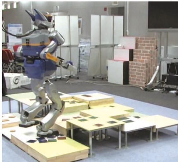
図2 歩容計画と未知凹凸路面適応制御の統合による自律移動
