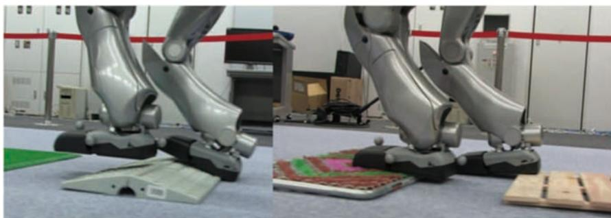
図1 未知の凹凸路面に適応する歩行制御
