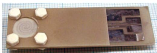
図1 高温液状物質用熱伝導度測定センサーの模式図と試作品
