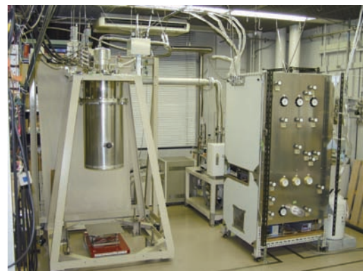
液体ヘリウム寒剤を必要としない温度計校正装置
