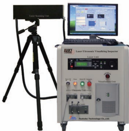
産総研技術移転ベンチャーで製品化したレーザ超音波可視化検査装置と内面傷を有するアルミ管（直径100mm）の可視化映像例
