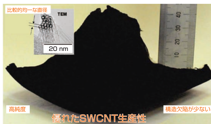
図3 合成されたSWCNT eDIPS法で製造したSWCNTは構造欠陥が少なく高品質という特徴がある。
