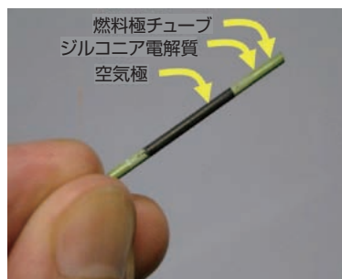
図1 チューブ型マイクロSOFC (1 W出力)
