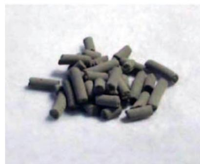
成型後の触媒の写真 (太さ約5 mm)
