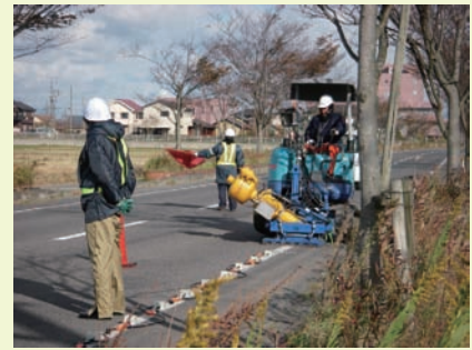
極浅層反射法地震探査の様子
