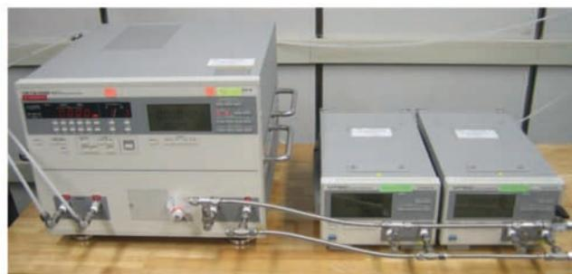
気体差圧の遠隔校正用仲介器(左)と校正器物(右) [遠隔地での設置例]
