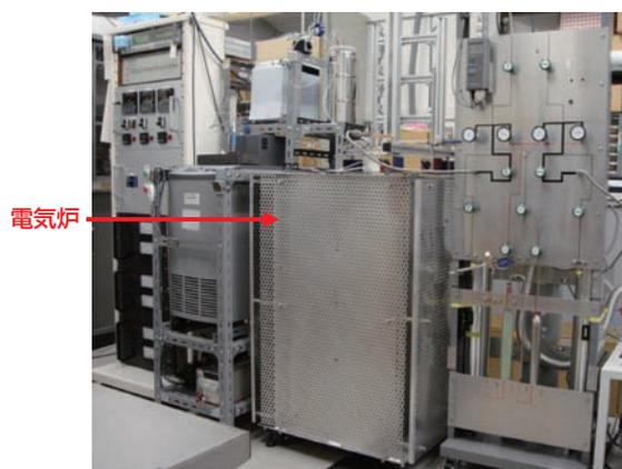
熱電対校正用 コバルト-炭素共晶点 実現装置
