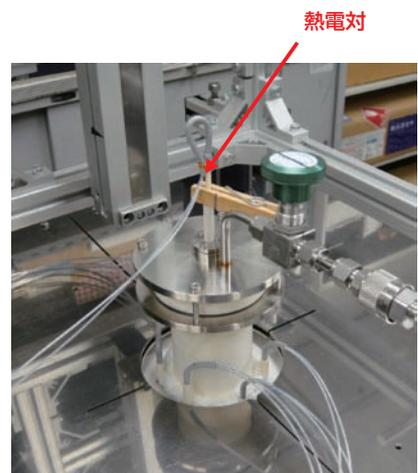
電気炉に挿入された熱電対
