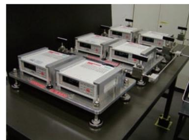
図2 デジタル圧力計を用いた国際比較用仲介器
