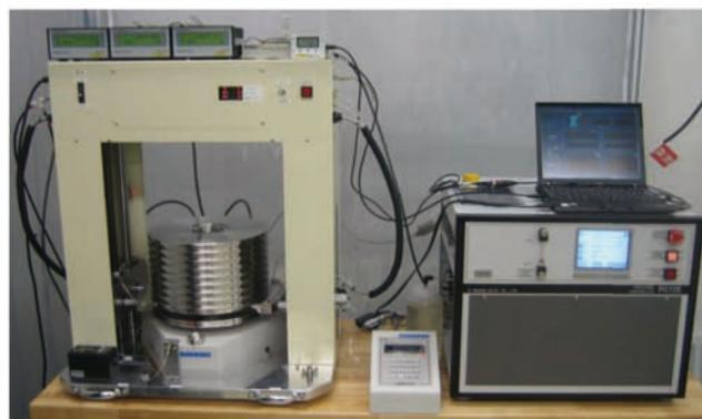
液体圧力の遠隔校正用仲介器(右)と標準器を用いた校正システム(左) [校正機関での設置例]
