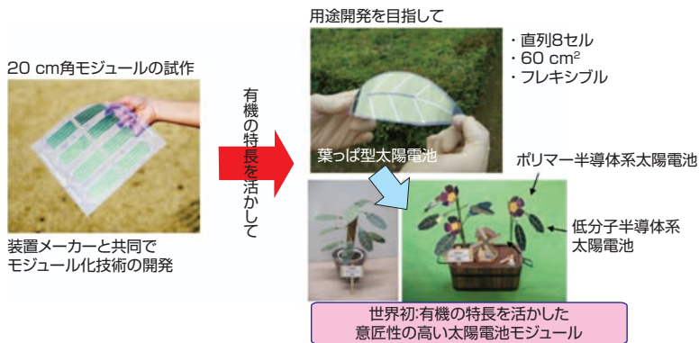
図3 20 cm角の有機薄膜太陽電池モジュール、葉っぱ型有機薄膜太陽電池モジュールの写真とその応用例
