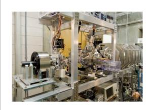
図1 陽電子プローブマイクロアナライザー
