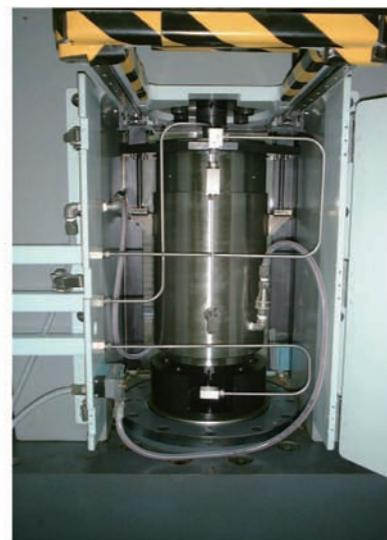
写真 ガス圧式高温高压岩石変形実験装置（左：システム全体、右：圧力容器）
