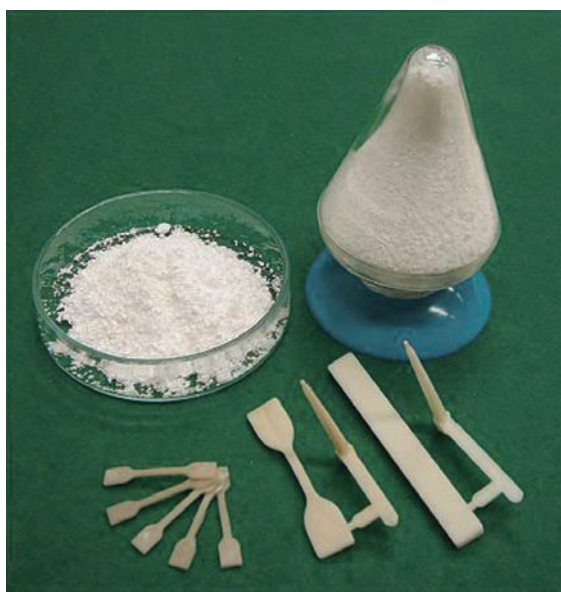
図2 ポリアミド4の射出成形品
