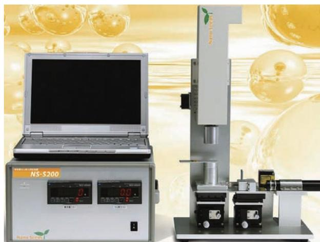
図4 化粧品の使用感（官能試験）を数値化できる評価装置
