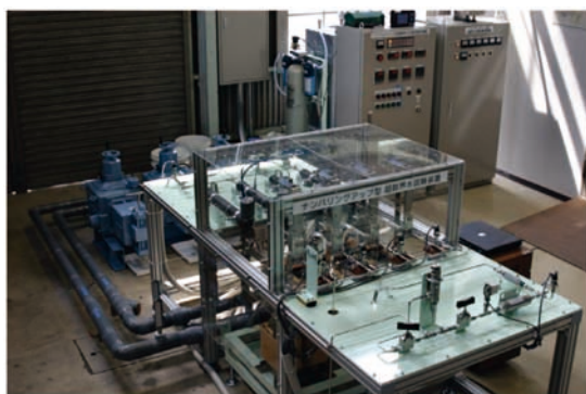
100 kg/時 級マイクロリアクタープラント (モジュールの4系列並列動作)
