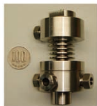
中心衝突型乱流ミキサー (接液部チタンライニング)
