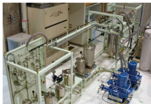
超高压超臨界水反応装置 (設計条件: 600℃・300 MPa)
