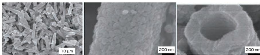
酸化タングステンナノチューブの走査型電子顕微鏡写真
