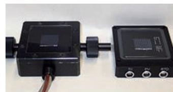
図2 基準セル (結晶系) の概観 (左: JIS 推奨型、右: 世界太陽電池スケール推奨型)
