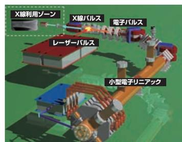
図1 レーザーコンプトン散乱エックス線発生装置
