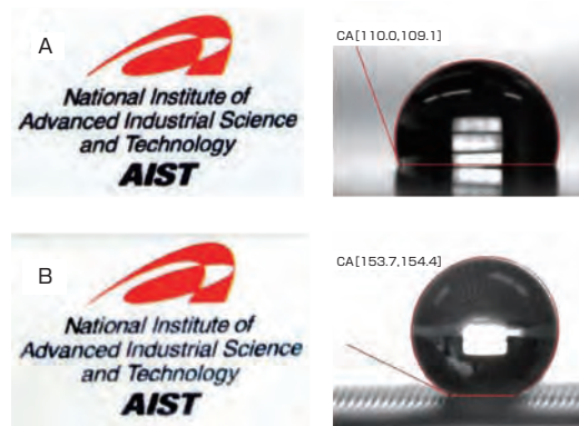
図2 A：AISTの文字上に置いた薄い透明なフッ素樹脂膜の熱転写前の写真と水の表面接触角 ( 110^\circ ) B：熱転写後の写真と水の表面接触角 ( 154^\circ )
