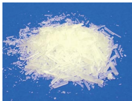
図2 蓄熱材として使用したスレイトール
