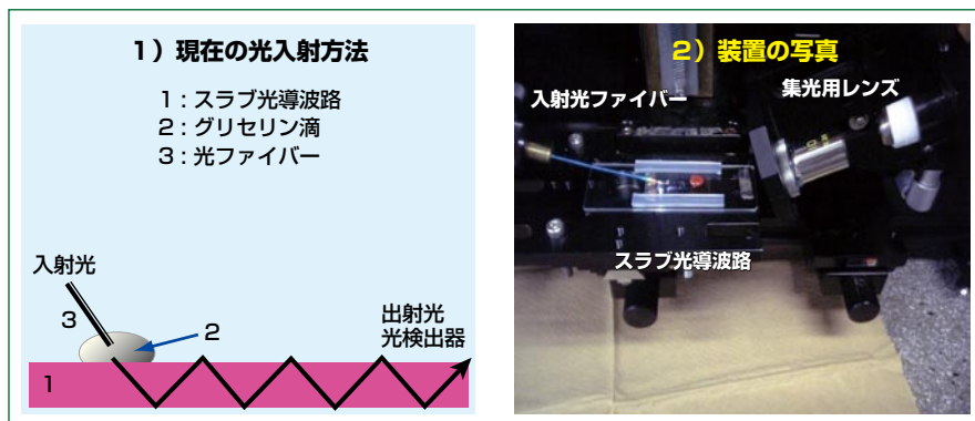
図1 スラブ光導波路分光法の模型図と写真
