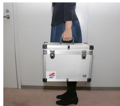
写真1 超小型電子加速器 (左) 加速器本体部。重量約 1.5 kg (右) 加速器システム一式。重量約 8 kg
