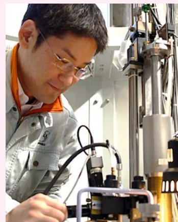
電磁振動プロセスによる金属ガラスの連続鋳造実験の様子
