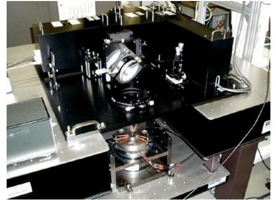
超高周波数用振動加速度校正装置 (5 kHz ~ 10 kHz)
