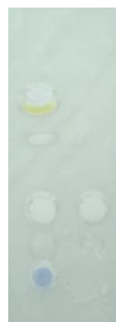
図2 抽出色素のシリカゲル薄層クロマトグラフ (黄色のスポットがデカプレノキサントンの色素成分、白色および青色のスポットは膜脂質類)
