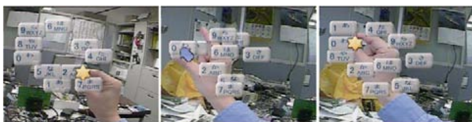
図1 カメラ付きヘッドマウントディスプレイ越しに実世界を見ている利用者が、自身の手の動きを使って暗証番号を入力している様子
