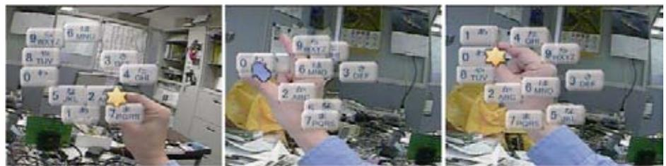
図1 カメラ付きヘッドマウントディスプレイ越しに実世界を見ている利用者が、自身の手の動きを使って暗証番号を入力している様子
