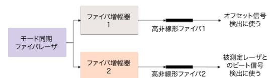
図2 光コムの構成。モード同期ファイバレーザにより発生した光コムは2つの増幅器で増幅され、高非線形ファイバで広帯域化される。
