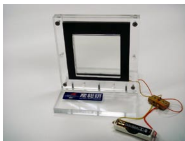
10 cm 角の調光ガラス試作品 (左: 消色状態 右: 着色状態)
