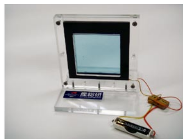
10 cm 角の調光ガラス試作品 (左: 消色状態 右: 着色状態)
