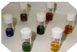
プルシアンブルーおよびその類似体による三原色インクとその混合による多色の実現
