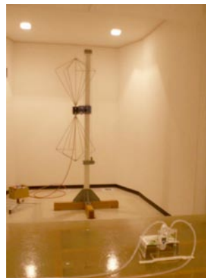
赤外線式体温計における電磁波試験の風景
