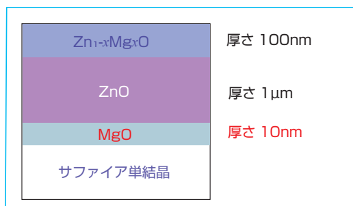
作製した試料の断面構造の模式図
